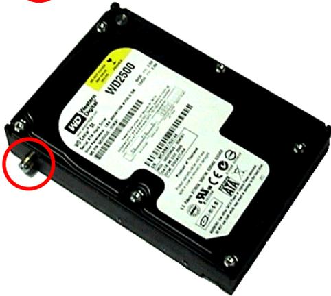
HDD имеет 6 отверстий для крепления. Установите коннектор SATA диска со стороны тела пользователя. Установите винт в левое крепежное отверстие жесткого диска.
